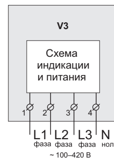
Схема 1. Упрощенная внутренняя схема и схема подключения
