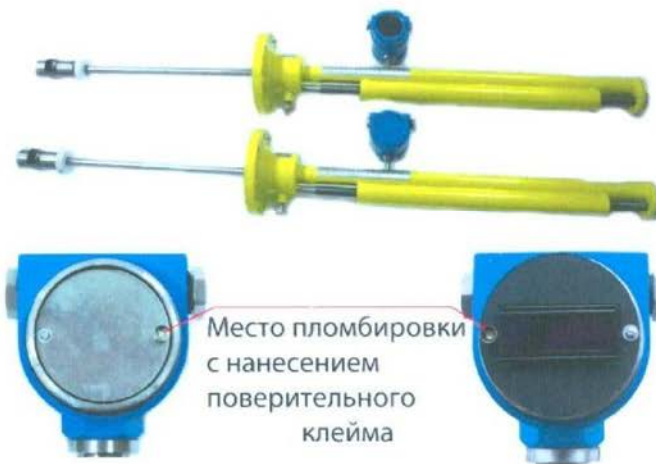
Рисунок 2 - Общий вид датчиков расхода газа ДРГ.М3 (И) с указанием мест пломбировки
