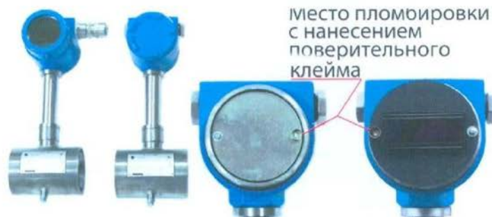
Рисунок 1 - Общий вид датчиков расхода газа ДРГ.М (И) с указанием мест пломбировки
